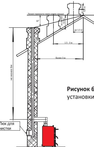
**Рисунок 6. Варианты установки дымовой трубы**
