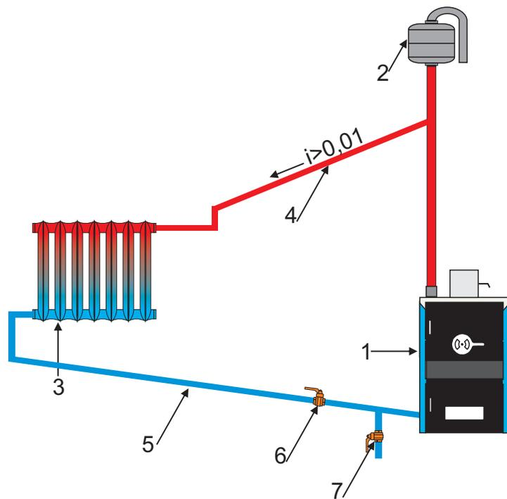
**Рисунок 2.1.** Схема присоединения котла к системе отопления открытого типа
