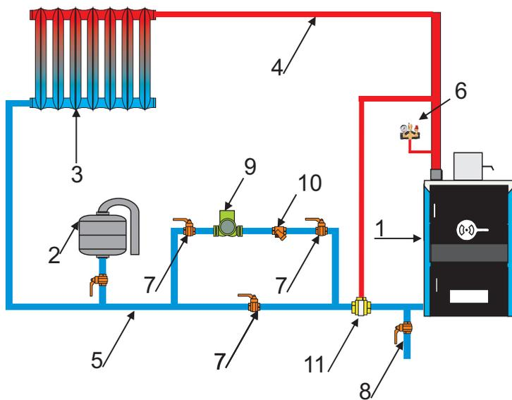
**Рисунок 2.2.** Схема присоединения котла к системе отопления закрытого типа
