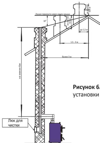
**Рисунок 6.** Варианты установки дымовой трубы
